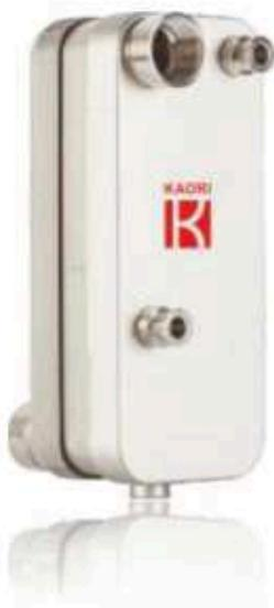
Серия "A" представляет инновационную разработку в области осушки воздуха. Объединяя в себе первичный охладитель, испаритель и сепаратор, теплообменник этой серии при малом размере обеспечивает высокую эффективность передачи тепла. Запатентованный сепаратор может идеально удалять влагу из сжатого воздуха, что позволяет отказаться от фильтра для очистки воздуха.
